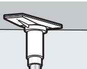
□取り付け後、家具が水平か、突っ張り棒が天井および家具と垂直かを確認してください。
