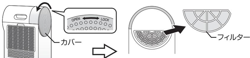
カバーを左に回してカバーを外します。
