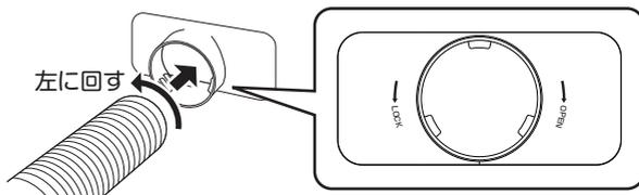
③排熱ダクト用継手のツメ(4箇所)を排熱口に差し込んでください。
