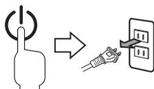
電源ボタンに触れて電源を切ってから、電源プラグをコンセントから抜いてください。
