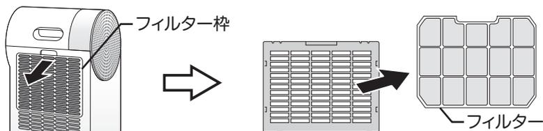
フィルター枠の中央上部を手前に引き、枠を外します。
