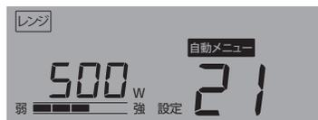
庫内灯が点灯、冷却ファンが回転して加熱が始まり、残り時間を表示します。
