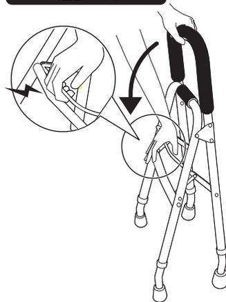
**2** プッシュピンで高さを調整して全体に締めがない事を確認して完成です。
