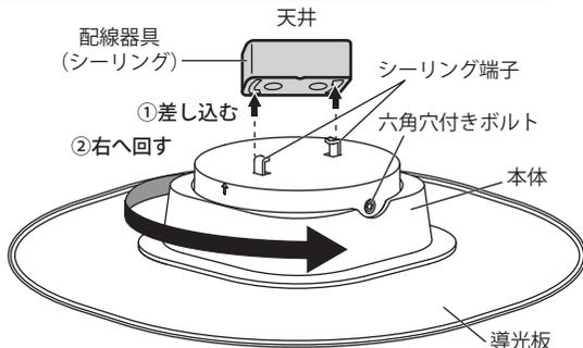
※取付け後、導光板の向きを調整できるよう導光板部分が90度の範囲内で回転します。お好みで調整してください。
