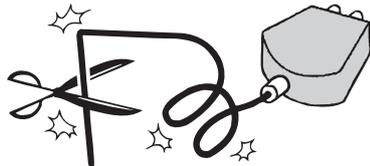
また、重たい物をのせたり、挟み込んだり、加工したりすると、電源コードが破損し、火災・感電の原因となります。
