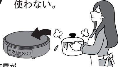
温度制御装置がはたらかず、異常加熱し火災の原因になります。
