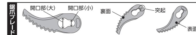
鋸爪ブレードは消耗品です。切れ味が悪くなったら交換してください。切れ味の悪い鋸爪ブレードや摩耗しすぎた鋸爪ブレードを使用されると機械に負担がかかり、故障の原因になります。
