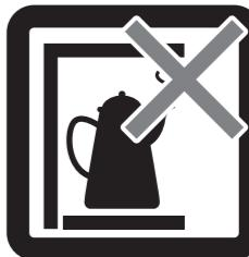
蒸気・熱によって変形・変色の原因になりますのでスライド棚は引き出してご使用ください
