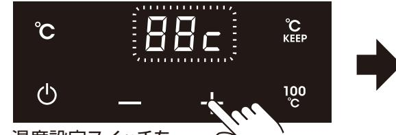
温度設定スイッチをタッチすると設定中の温度が点滅します。
