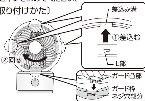
ガード側面のL部(×3)と凸部(×1)を本体端の溝に差し込んでからガードを時計回りに回しネジを締める。
