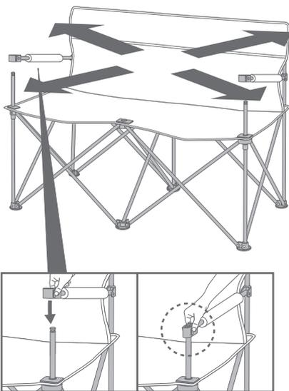
肘先端の接続部を押し込みます。
