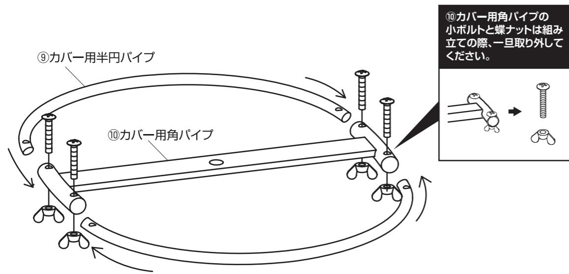
**6** 回転軸を下図の様に分解し、**4**で組み立てたカバー用角パイプに取り付けた後**5**で組み立てたハンガー本体の回転軸受けに差し込んで下さい。
