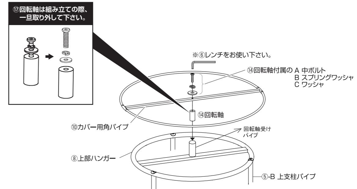
**5** **3**で仕上げた上支柱の上に、上部ハンガーを下図の様に取り付けて下さい。
