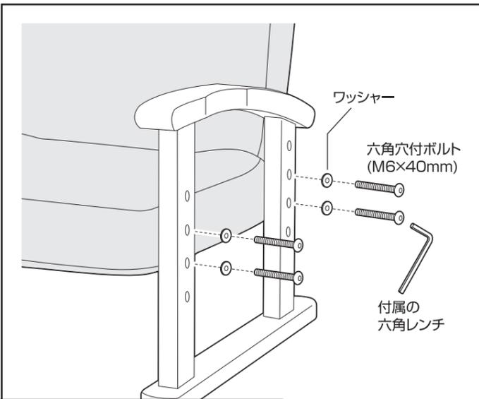
**！** 左右の脚部は必ず同じ高さになるよう取り付けてください。
