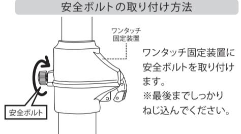
ワントッチ固定装置に安全ボルトを取り付けます。
