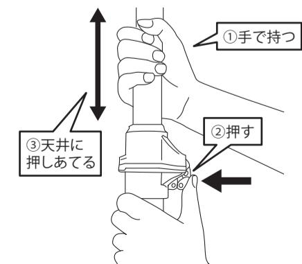
上部パイプを手で持ち、ワンタッチボタンを押すと上部パイプが伸縮自在になり、ワンタッチボタンから指を離すと上部パイプが固定されます。
