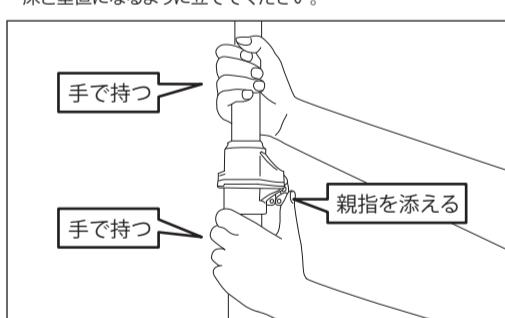
②上部パイプを持ったままワンタッチボタンを押し、ワンタッチボタンを押したまま天井に接するまで上部パイプを引き上げます。
