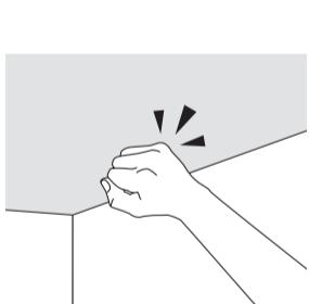
設置前に必ず天井・床の強度を確認ください。天井の強度が弱い際にはサンなどのある位置に取り付けるか、市販のあて板をご利用ください。取り付け・取り外し時の天井・床への損傷については責任を負いかねます。
