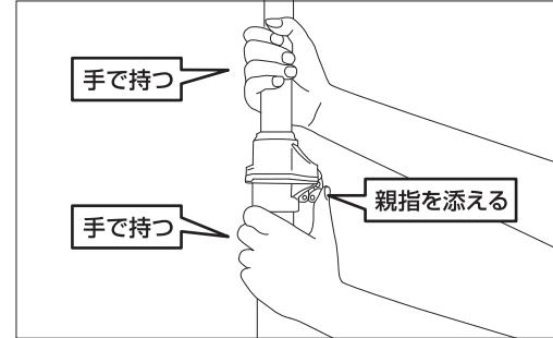
②上部パイプを持ったままワンタッチボタンを押し、ワンタッチボタンを押したまま天井に接するまで上部パイプを引き上げます。
