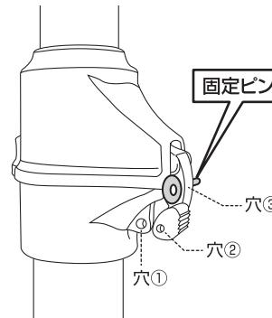
組み立て終わったら、固定pinを穴③に差し込みます。パイプ落下防止となります。
