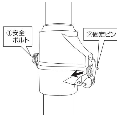
①安全ボルトの締め付けをゆるめて、
