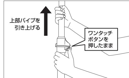
③天井に接したら、スイッチから手を放し、上部は上方向に、下部は下方向に、力を入れて引っ張ります。
