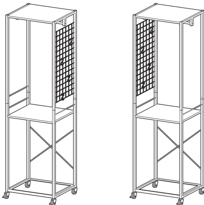
2 組み立てたフレームに棚板を取り付けます。
