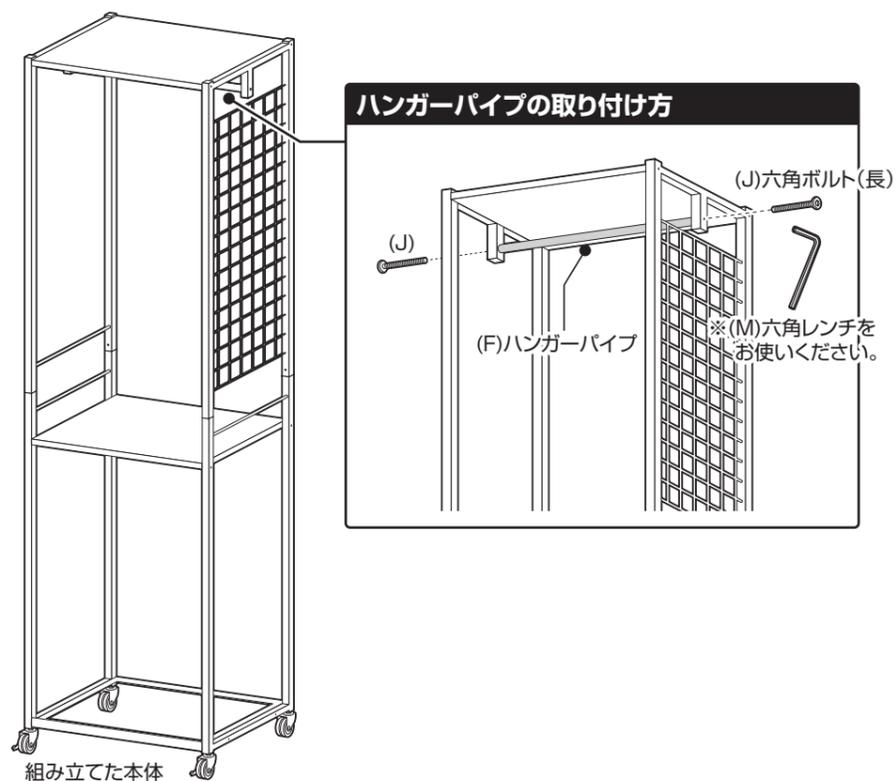
8 組み立てた本体にS字フックを取り付けます。最後に、各部にゆるみがない事を確認して完成です。
