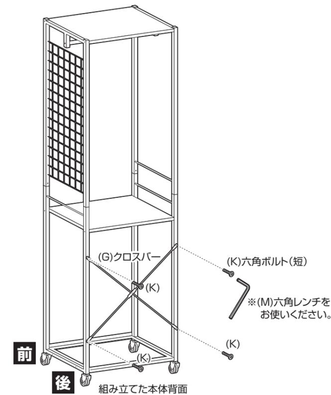
6 組み立てた本体を起し、ハンガーパイプを取り付けます。
