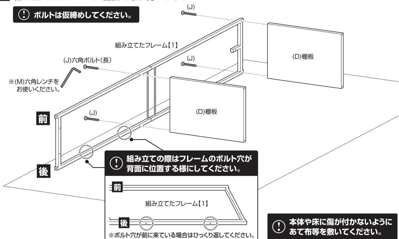
3 組み立てた本体に底部フレームを取り付けます。
