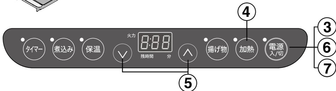
③ 電源入/切 キーを押します。電源が入り、電源ランプが点灯します。
