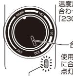
温度調節ダイヤルの 合わせマークを 「230」 に合わせる
