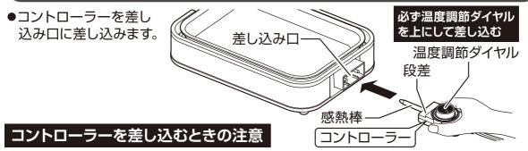
※コントローラーは、段差が差し込み口に隠れるまで確実に差し込んでください。 差し込みが浅かったり、斜めに差し込んだり、調理くず、油、汚れ、ホコリが付着したまま 差し込むと、故障して使用できなくなったり、発煙・感電・火災の原因になります。
