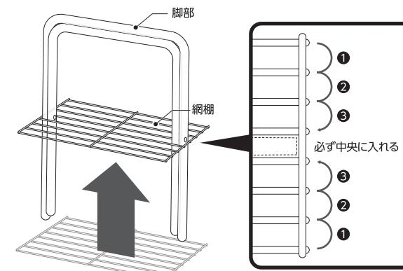
2 網棚が脚部の交差部分に固定されるように開きます。
