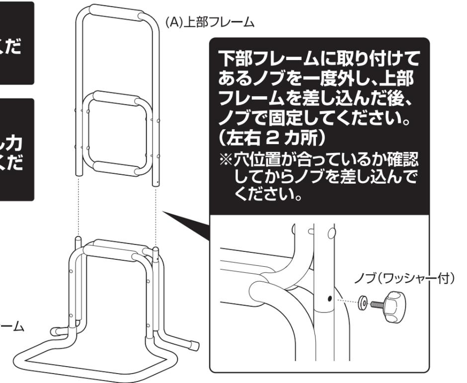
下部フレームに取り付けてあるノブを一度外し、上部フレームを差し込んだ後、ノブで固定してください。(左右2カ所)
