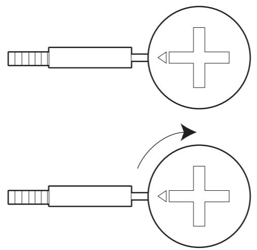
■カムロックナットをマイナスドライバーで時計回りに固くなるまで締め付ける。
