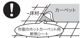
断熱をしないと、床材の変色・変形・割れなどの原因となります。
