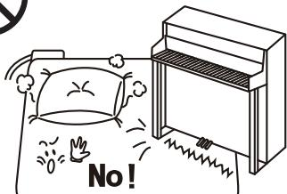
部分的に保温した状態で長時間使用されると、カーペット本体がヒーター線に沿う形で変色し、故障や床面(畳、フローリングなど)の変色・変形の原因となります。また、重い物を長期的に置かれますと、ヒーター線が劣化しやすくなります。部分的に温度が高くなり、ヒーター線を傷めて発火したり、異常動作をしたりしてやけどをするおそれがあります。
