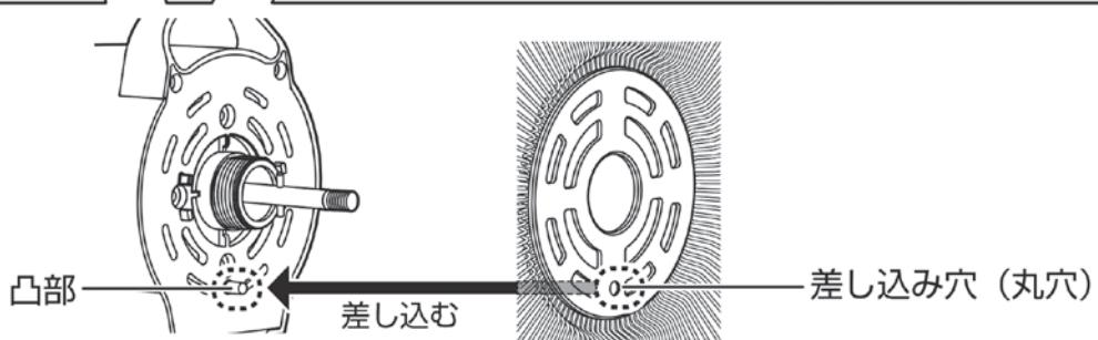
後ガードの差し込み穴 (丸穴) を下にして、モーター部前面の凸部に後ガードの差し込み穴 (丸穴) を差し込みます。
