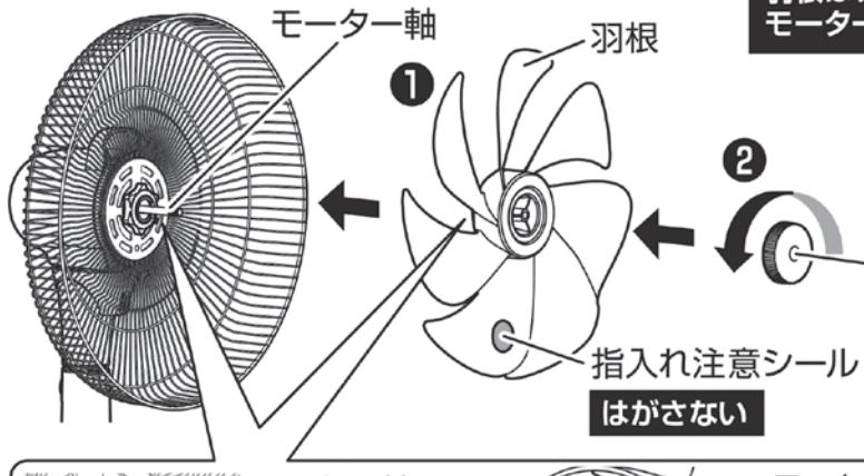
羽根は、羽根裏面中央部の凹部をモーター軸側にして差し込む
