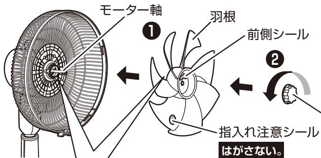
羽根中央部の平らな面に貼ってある「前側」シールを手前側にして羽根を差し込む。
