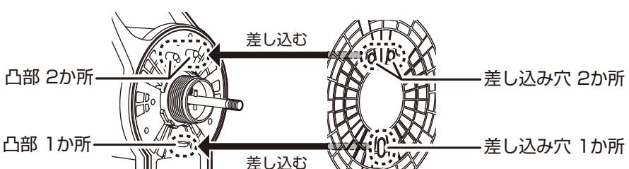
後ガードの差し込み穴が2か所ある側を上にして、モーター部前面の凸部3か所に後ガードの差し込み穴3か所を合わせて差し込みます。
