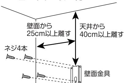
壁面に壁面金具をネジでしっかりと固定してください。
