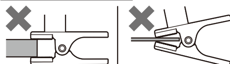
差し込みかたが浅い状態
