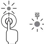
電源ランプと風量ランプ(弱)が点灯し、再度押すと停止します。
