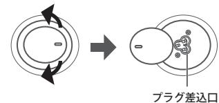
2. 水平で安定した場所に本体と蓄熱用電源コードセットを図のように置いてください。
