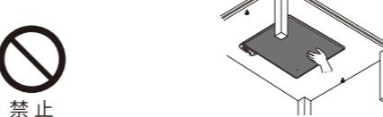
やけどの原因になります。布が破損し内部の絶縁部が剥がれ、火災や感電、故障の原因になります。
