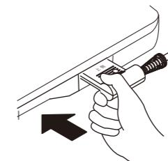
※ 器具用プラグを逆に差し込んでしまったり、斜めになつた状態で差し込んでしまいますと、器具用プラグ、器具用プラグ受けが破損、変形する恐れがあります。
