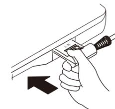
※ 器具用プラグを逆に差し込んでしまったり、斜めになった状態で差し込んでしまうと、器具用プラグ、器具用プラグ受けが破損、変形する恐れがあります。
