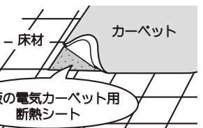
断熱をしないと、床材の変色・変形・割れ・すき間の原因になります。
