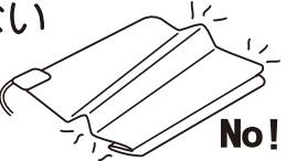
内部の発熱体を傷め、火災・感電・故障の原因になります。
