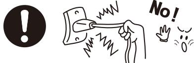
コードを引っ張ると、コードが破損し、感電・ショート・火災の原因になります。
