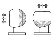
上下首振りボタンを押すと、上下(約90度)に首振り動作し、上下首振りランプが点灯します。再度押すと上下首振り動作を停止します。
