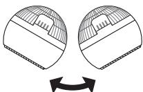
左右首振りボタンを押すと、左右(約60度)に首振り動作し、左右首振りランプが点灯します。再度押すと左右首振り動作を停止します。
