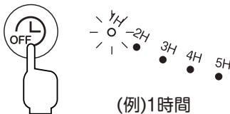
運転中に切タイマー ボタンを押すと、切タイマー ランプが点灯し、切タイマーのセットができます。切タイマー ボタンを押すたびに設定時間がかわります。
