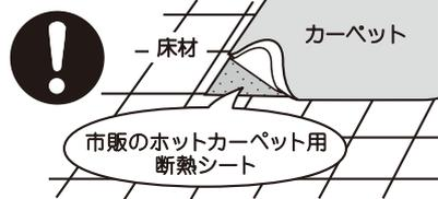
断熱をしないと、床材の変色・変形・割れ・すき間の原因になります。
