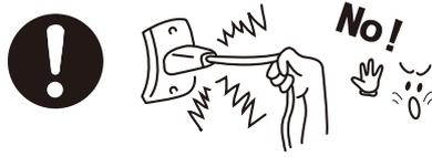
コードを引っ張ると、コードが破損し、感電・ショート・火災の原因になります。
