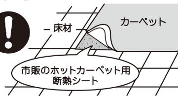
断熱をしないと、床材の変色・変形・割れ・すき間の原因になります。
