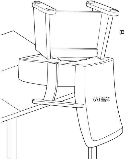
**3** 脚部と座部のボルト穴の位置を合わせ、座部に脚部を固定します。ボルトは仮締めしてください。
