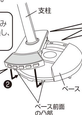
3 支柱後部のフックをベース後部のフック穴に合うようにはめ込みます。
