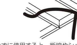
電源コードを固定せずに使用すると、断線やショートを引き起こし、火災や感電、故障の原因になります。
