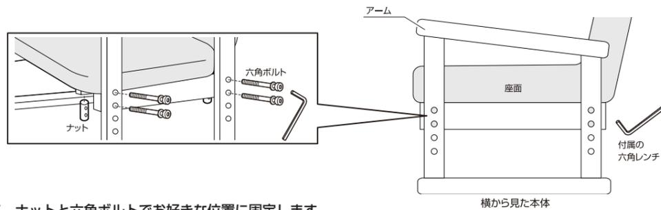
椅子を裏返して、ナットと六角ボルトでお好きな位置に固定します。4ヶ所同様に固定してください。
