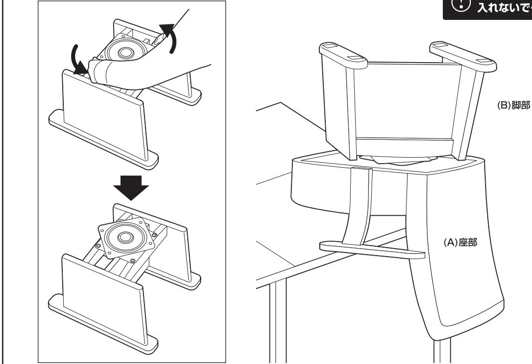
3 脚部と座部のボルト穴の位置を合わせ、座部に脚部を固定します。
