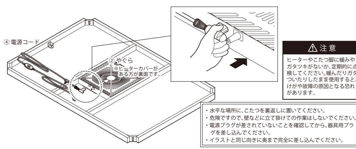
2 コードフックを脚のコード吊り穴に引っ掛けて固定し、コードを適切な長さに調整します。
