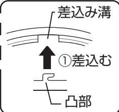
ガードの裏面の凸部(3ヶ所)を本体の端にある溝に差込んでからガードを図の方向に回し、ネジを締める。
