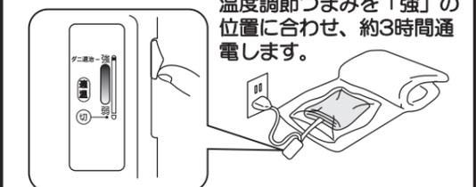
温度調節つまみを「強」の位置に合わせ、約3時間通電します。
