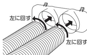
③排熱ダクト用継手のツメを本体の溝に取り付けてください。
