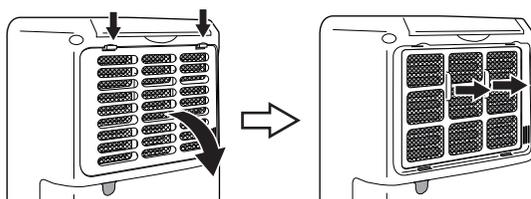
ツメ(×2)を押して枠を外します。
