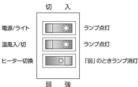
ヒーター切換スイッチで、ヒーターの強弱を切り換えます。
