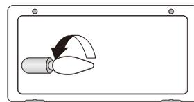
①背面の電球交換口の2本のネジをドライバーで取り外す。
