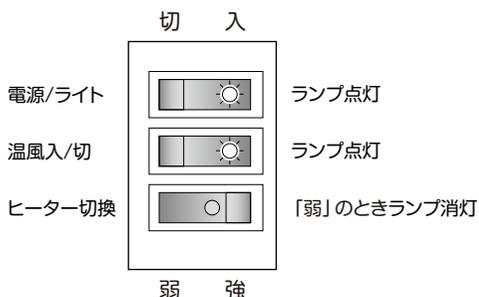
ヒーター切換スイッチで、ヒーターの強弱を切り換えます。
