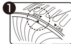
前ガードの「▲」マークが後ガードの「はずす▼」マークに合うまで前ガードを反時計回りに回す
