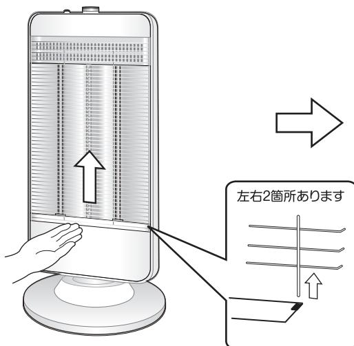
②ガード下部を手前に引出し、下方向にガードを引き抜きます。
