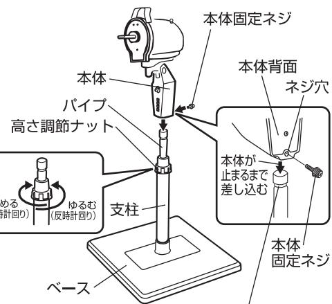
本体を差し込みパイプの溝部で本体固定ネジを締付ける
